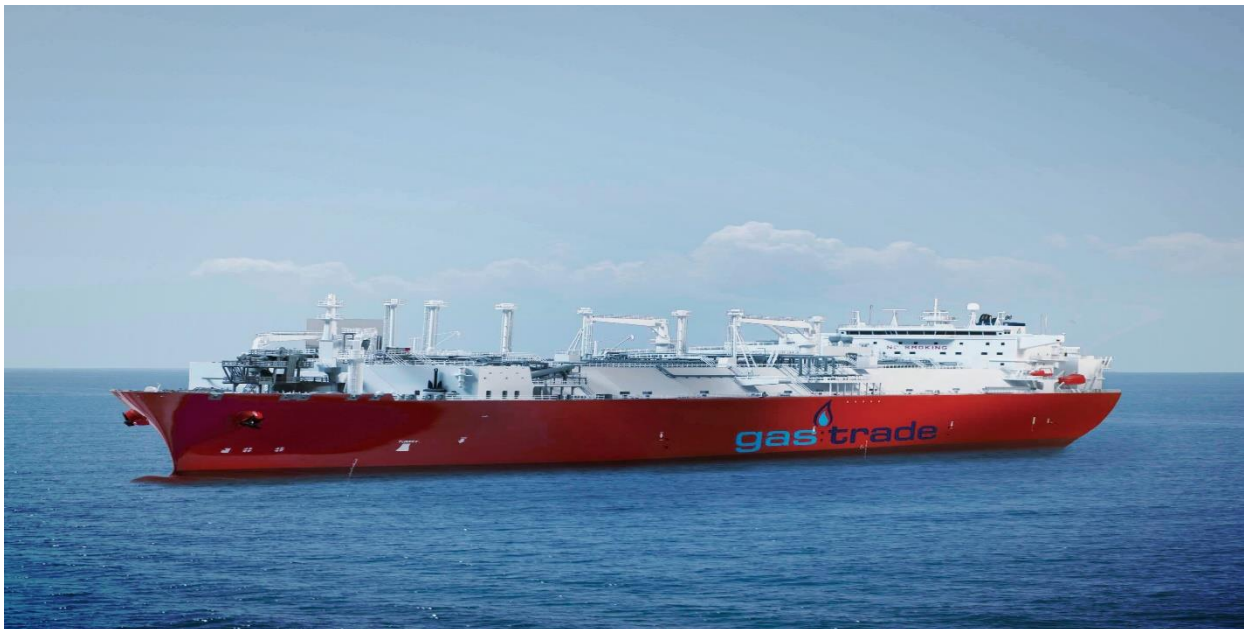
Σχήμα 1.11: Η πλωτή μονάδα παραλαβής, αποθήκευσης και αεριοποίησης ΥΦΑ (Gastrade A.E., n.d.)
